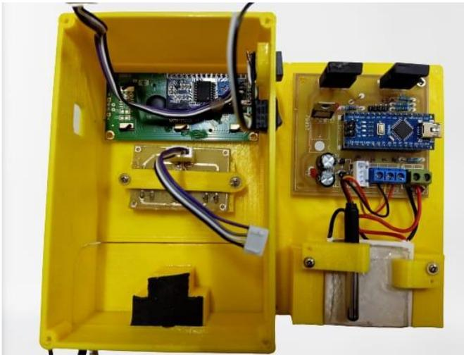
Gambar 4. Desain Kalibrasi Termometer Badan Berbasis Kontrol PID
