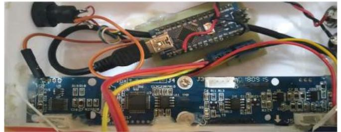
Fig. 5. Tampak hasil rancangan modul dengan arduino nano dan sensor gasboard 7500e
