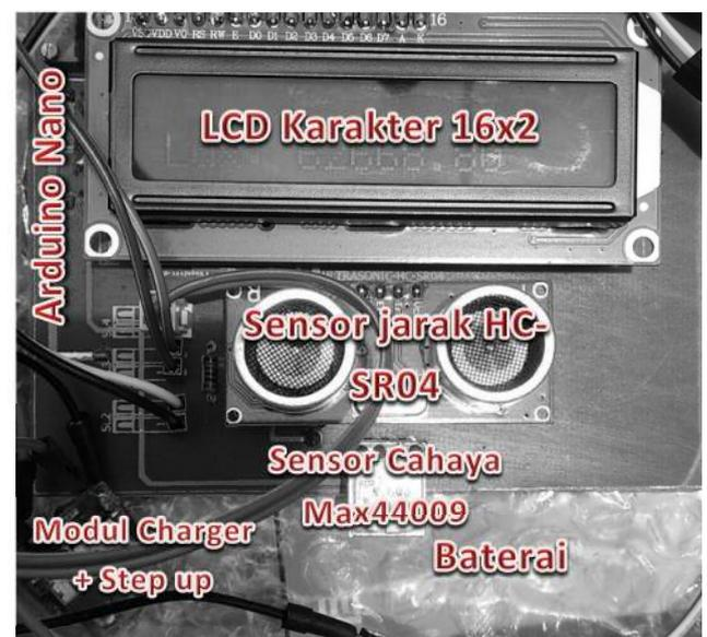
Gambar 4. Desain Luxmeter dilengkapi Sensor Jarak
