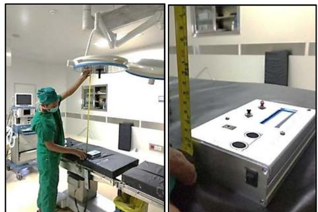
Gambar 6. Pengujian Lampu Operasi Parameter Pengukuran jarak 100 cm
