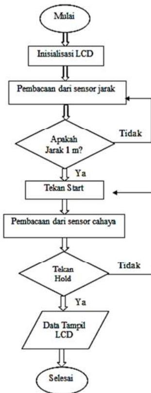
Gambar 2. Diagram Alir Luxmeter Dilengkapi Dengan Sensor Jarak
