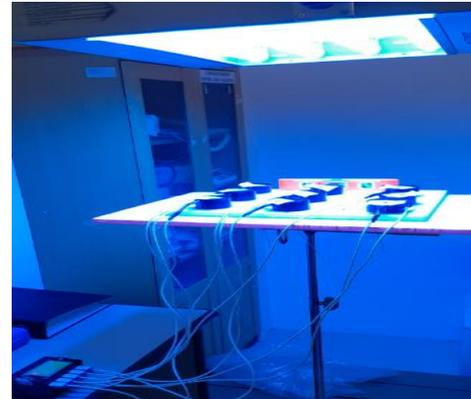
Gambar 7 Penempatan sensor pada pengukuran alat fototerapi
