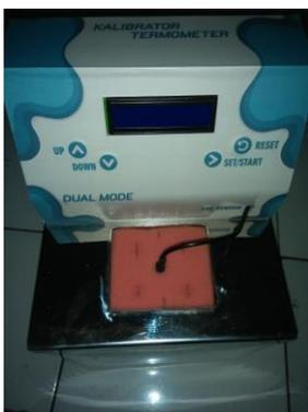
Gambar. 4. Desain perancangan kalibrator termometer digital menggunakan media air
